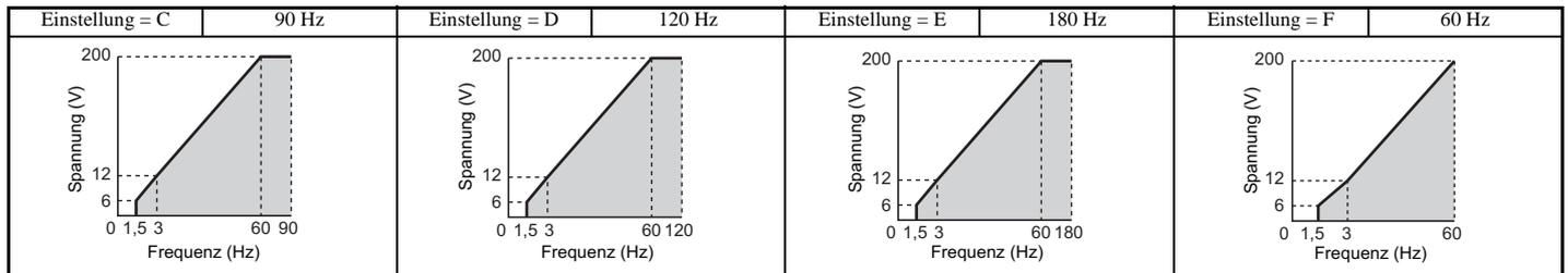
**Einstellung einer anwenderspezifischen U/f-Kennlinie (Einstellung F Werkseinstellung)**
