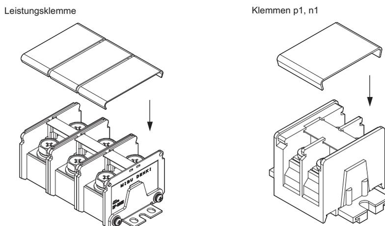
Abbildung 3.23 Schutzabdeckung (2□0104 bis 2□0248, 4□0096 bis 4□0414)
