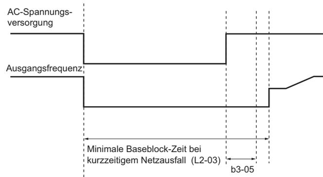
**Abbildung 5.18 Ablaufdiagramm für die Fangfunktion nach einem kurzzeitigem Netzausfall**
