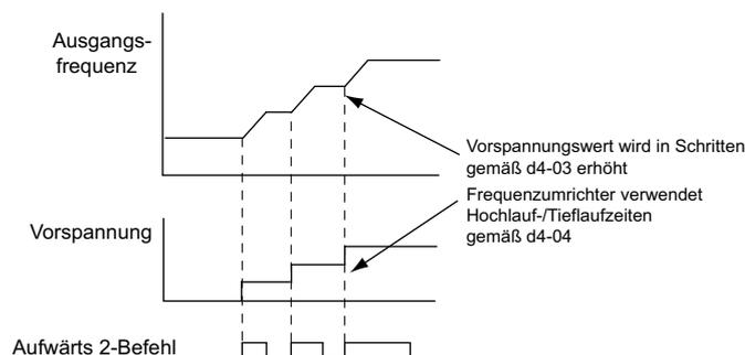
Abbildung 5.50 Vorspannung Aufwärts/Abwärts 2 bei d4-03 > 0,0 Hz
