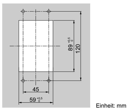
**Abbildung 2.13** Abmessungen des Schrank-Ausschnittes (Interne/Einbaumontage)
