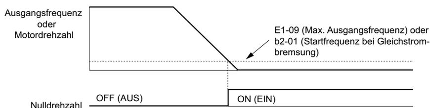
Abbildung 5.67 Ablaufdiagramm für Nulldrehzahl
