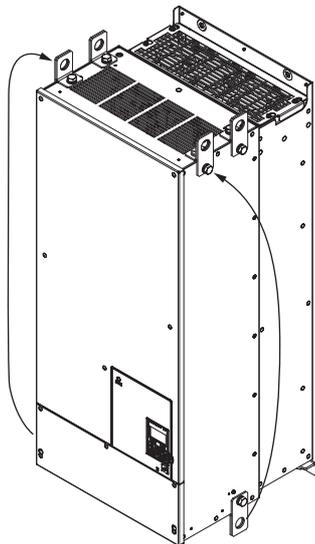
**Abbildung 2.6** Lage der Befestigungswinkel (2□0154 bis 2□0248, 4□0156 bis 4□0414)
