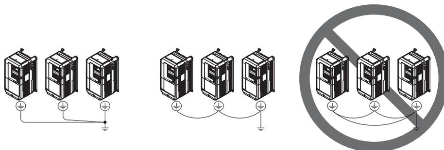
Abbildung 3.24 Verkabelung mehrerer Frequenzumrichter
