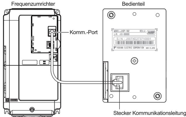
Abbildung 2.8 Anschluss des Kommunikationskabels
