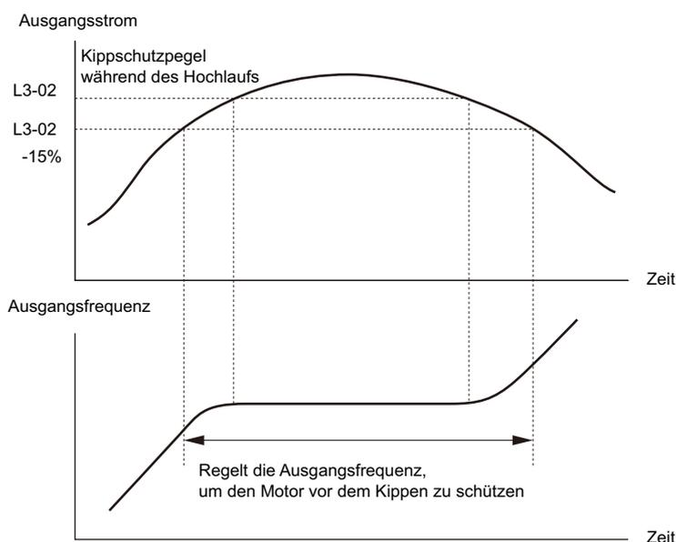
Abbildung 5.91 Kippschutz beim Hochlauf für Asynchronmotoren
