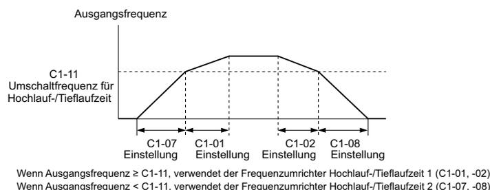
**Abbildung 5.33 Umschaltfrequenz für Hochlauf-/Tief Laufzeit**
