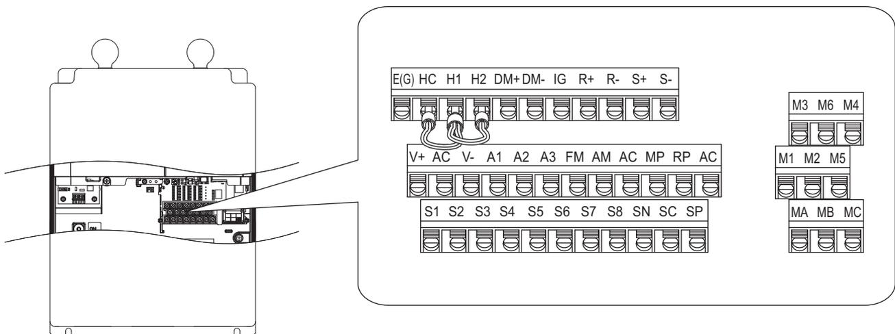
**Abbildung 3.26 Anordnung der Steuerkreisklemmen**
