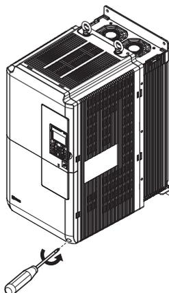
Abbildung 3.8 Entfernen der Klemmenabdeckung
