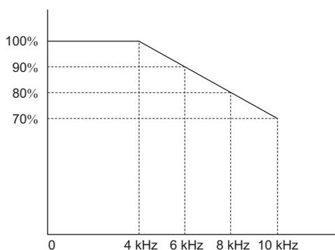
**Abbildung A.1 Taktfrequenz-Derating**
