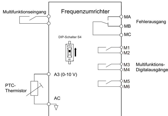
Abbildung 5.89 Anschluss eines Motor-PTC
