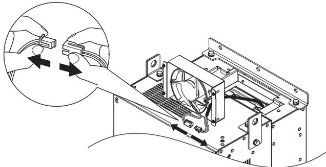
Abbildung 7.25 Steckverbindung der Lüftereinheit lösen
