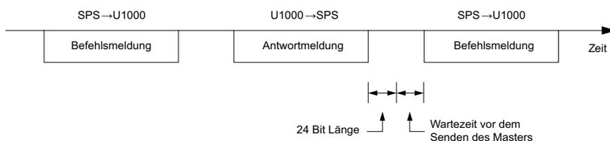
**Abbildung C.6 Minimale Wartezeit für das Senden von Meldungen**
