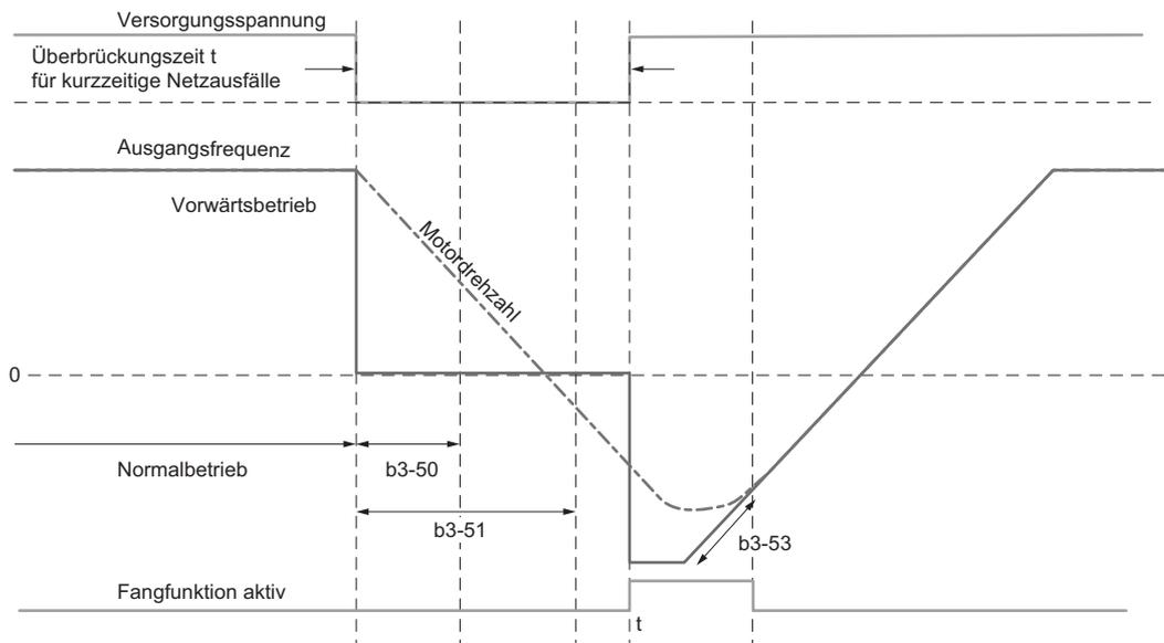
Abbildung 5.22 Fangfunktion in der entgegengesetzten Drehrichtung des Richtungsbefehls ( $b3-50 \leq t < \infty$ )
