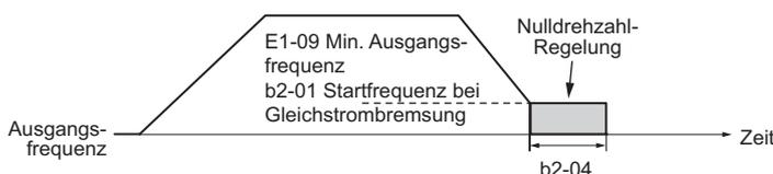
Abbildung 5.17 Nulldrehzahl-Regelung beim Anhalten in CLV und CLV/PM
