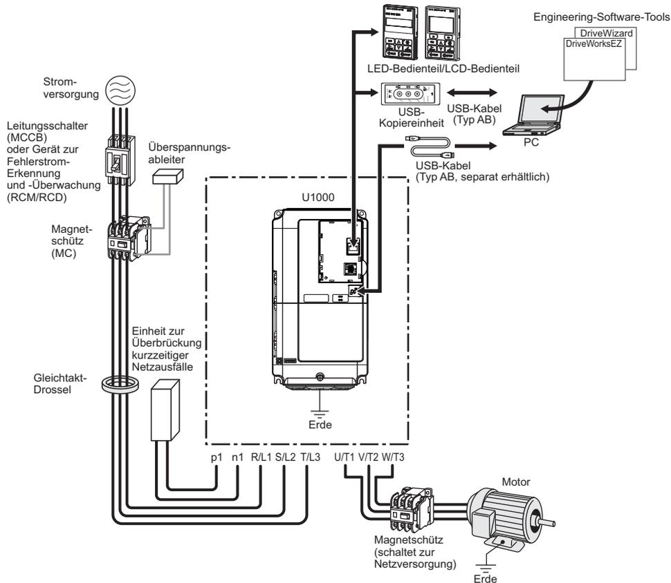
Abbildung 8.1 Anschluss von Peripheriegeräten
