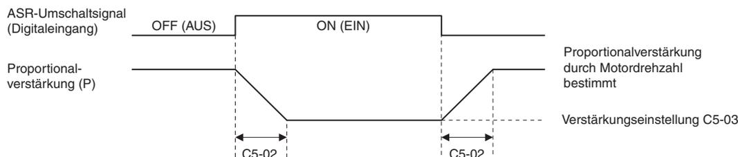
Abbildung 5.41 Umschaltung der ASR-Proportionalverstärkung
