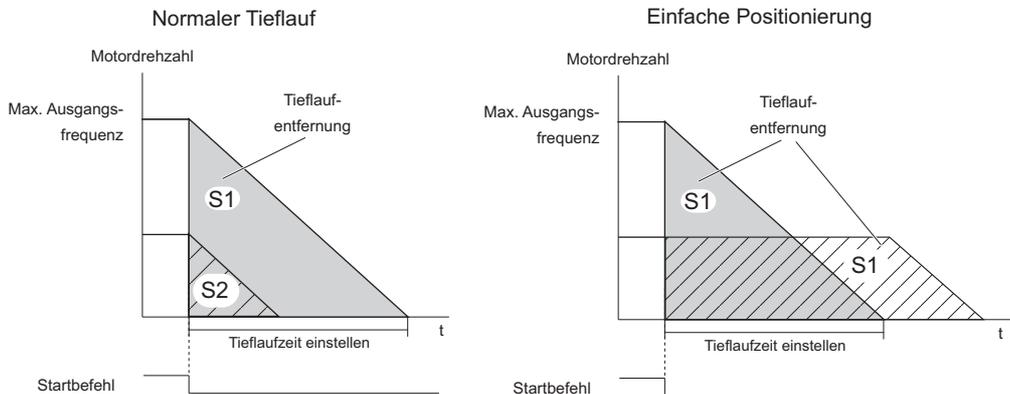
Abbildung 5.11 Einfacher Positioniertieflauf
