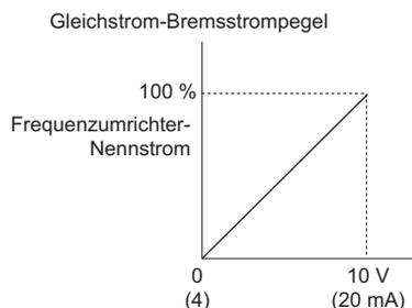
Abbildung 5.82 Gleichstrom-Bremsstrom mit Analogeingangsklemme
