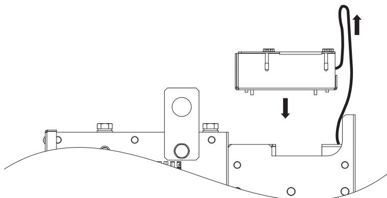
**Abbildung 7.17 Einbau der Lüftereinheit**
