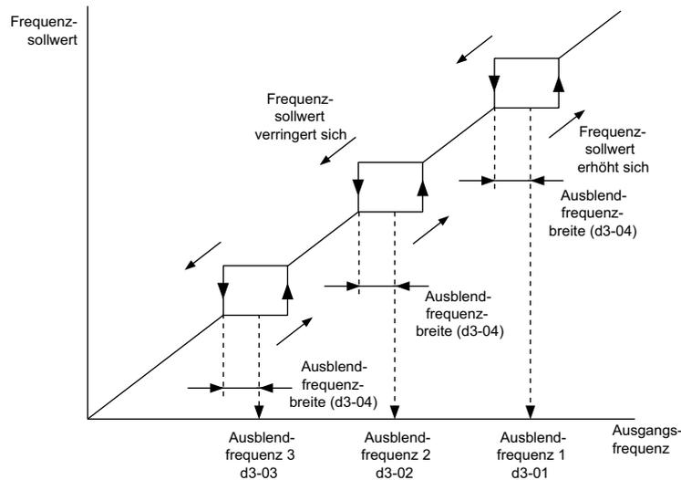
Abbildung 5.45 Ausblendfrequenz-Funktion
