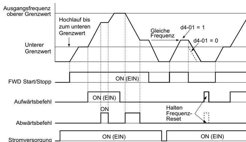
Abbildung 5.59 Betrieb mit Aufwärts-/Abwärtsbefehl
