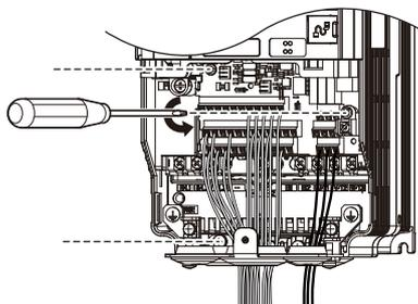
Abbildung 7.38 Lösen der Steuerkreisklemmen-Baugruppe
