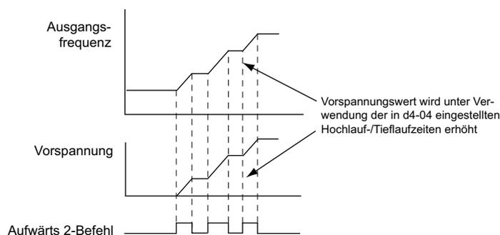
Abbildung 5.49 Vorspannung Aufwärts/Abwärts 2 bei d4-03 = 0,0 Hz
