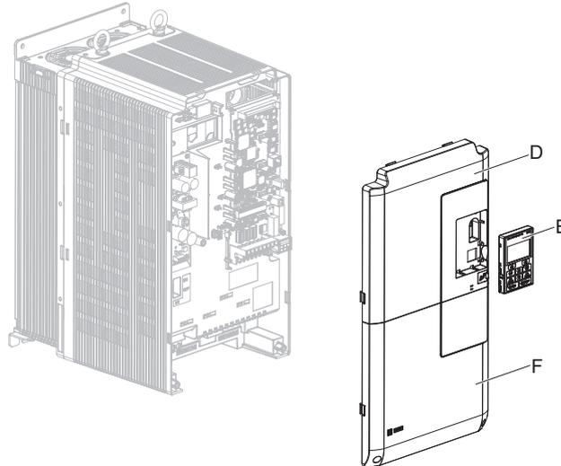
Abbildung 8.15 Wiederanbringen der Frontblenden und des Bedienteils
