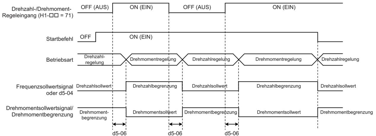
Abbildung 5.52 Umschaltzeit Drehzahl-/Drehmomentregelung
