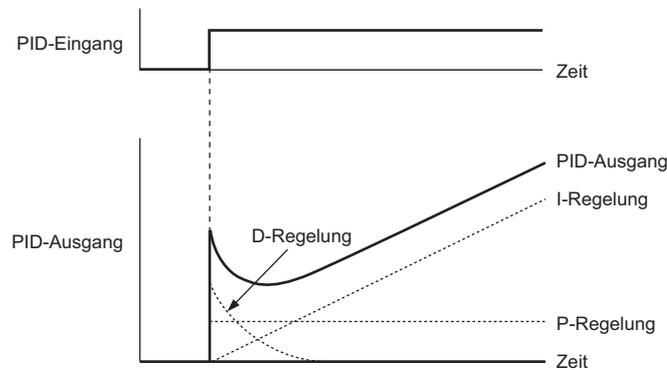
Abbildung 5.24 Funktionsweise der PID-Regelung
