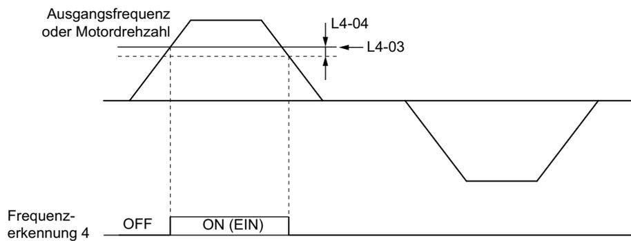
Abbildung 5.75 Beispiel für Frequenzerkennung 4 mit positivem L3-04-Parameterwert
