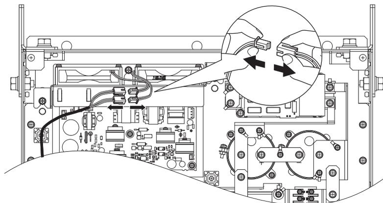
Abbildung 7.33 Steckverbindung der Lüftereinheit lösen
