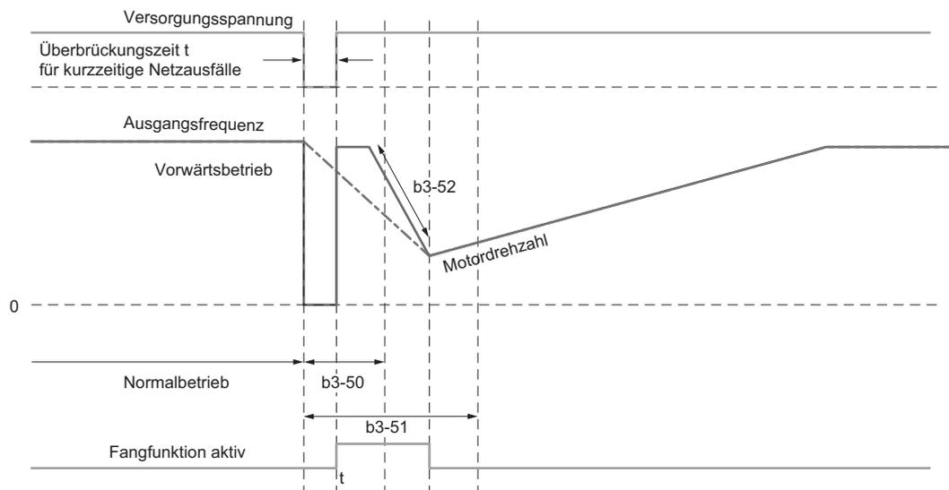
**Abbildung 5.20** Fangfunktion von einem Vorwärts-Startbehl ausgehend
