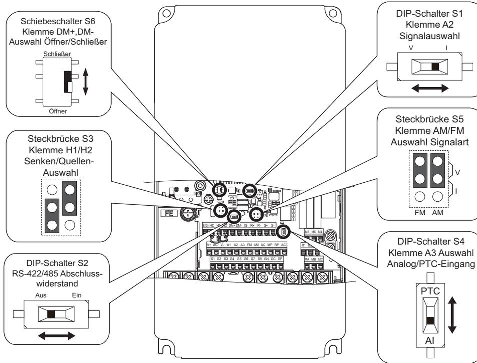
Abbildung 3.31 Lage der Steckbrücken und Schalter an der Steuerkreisklemmen-Baugruppe
