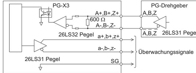
Abbildung 8.13 Schnittstellenschaltung (PG-X3)
