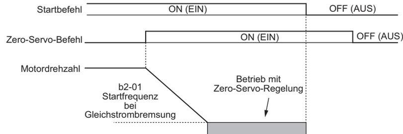
Abbildung 5.31 Betrieb mit Zero-Servo-Regelung
