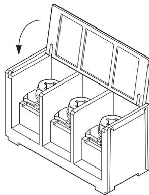
Abbildung 3.22 Schutzabdeckung der Leistungsklemmen (2□0028 bis 2□0081, 4□0011 bis 4□0077)
