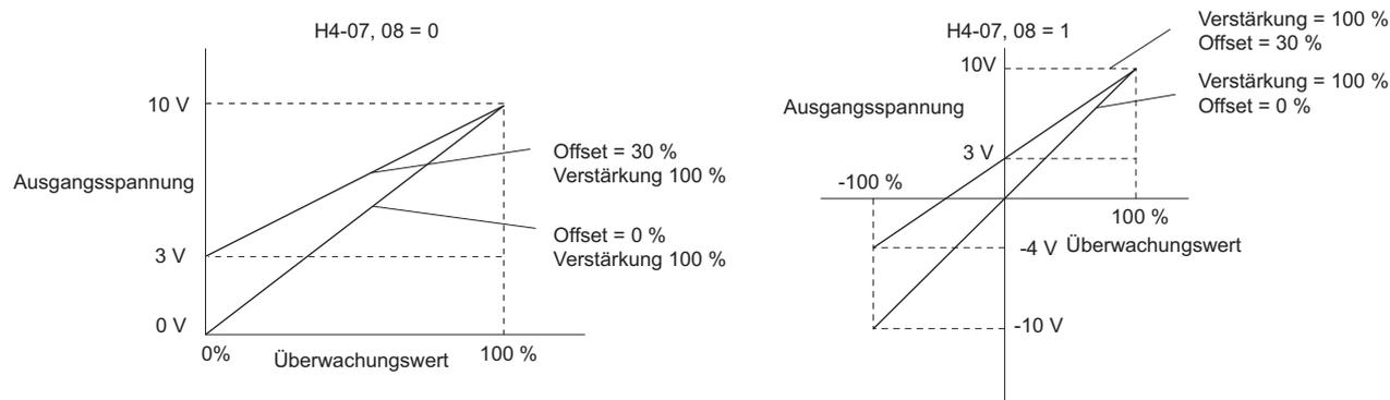
Abbildung 5.85 Beispiel 3 für Verstärkungs- und Vorspannungseinstellung für Analogausgang
