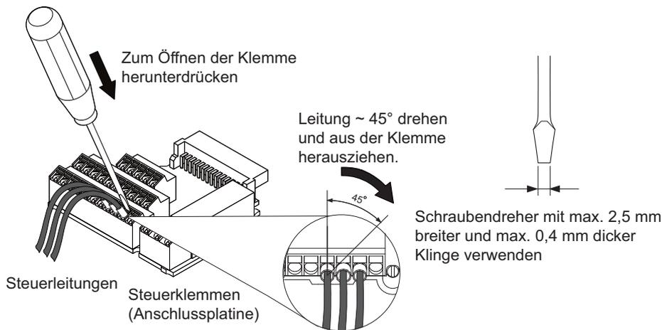
**Abbildung 3.29** Entfernen von Leitungen aus der Steuerkreisklemmen-Baugruppe
