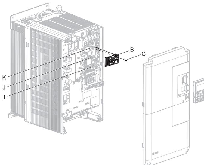
Abbildung 8.4 Einsetzen der Optionskarte
