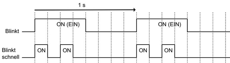
Abbildung 4.3 RUN-LED Status und Bedeutung
