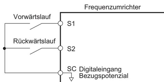
Abbildung 5.64 Beispiel eines Stromlaufplans für 2-Draht-Ansteuerung
