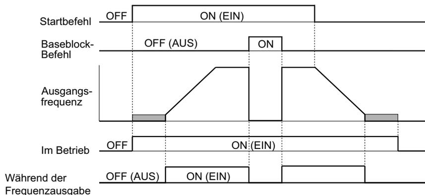
Abbildung 5.77 Ablaufdiagramm für Frequenzabgabe
