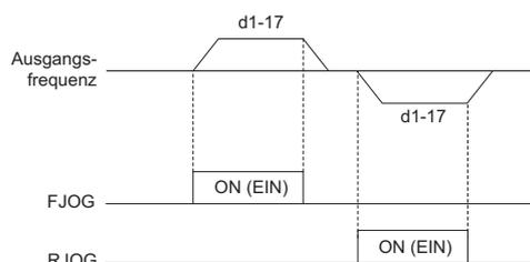
Abbildung 5.60 FJOG/RJOG-Betrieb
