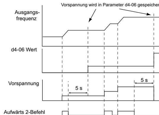
Abbildung 5.48 Beispiel für Aufwärts/Abwärts 2 mit Frequenzsollwert aus anderer Eingangsquelle als das digitale Bedienteil und d4-01 = 1
