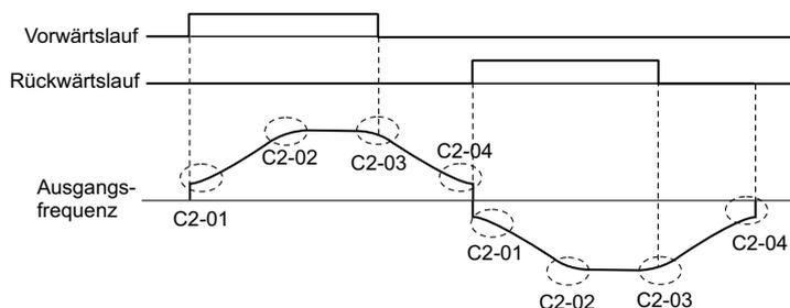
Abbildung 5.34 Ablaufdiagramm für S-Kurven - FWD/REV-Betrieb
