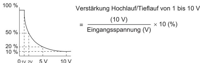
Abbildung 5.81 Hochlauf-/Tieflaufzeit-Verstärkung mit Analogeingangsklemme
