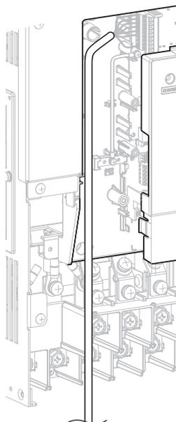
**Abbildung 8.14 Beispiele für das Verlegen der Leitungen**
