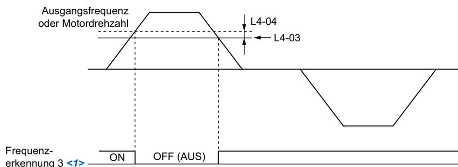
Abbildung 5.74 Beispiel für Frequenzerkennung 3 mit positivem L3-04-Parameterwert
