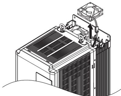
Abbildung 7.3 Ausbau des Lüfters
