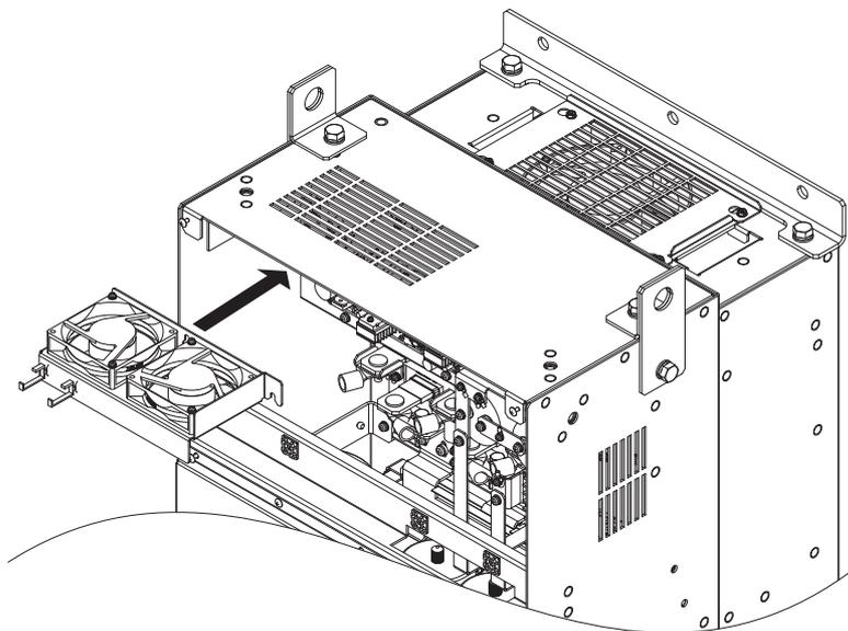
Abbildung 7.35 Einbau der Umlüftereinheit
