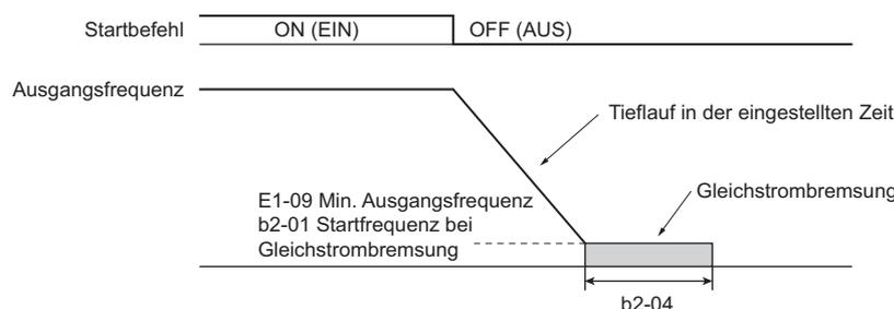
Abbildung 5.3 Gleichstrombremsung bei Anhalten für U/f, U/f mit PG und OLV
