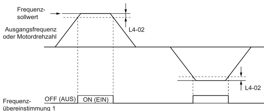
Abbildung 5.68 Ablaufdiagramm für Frequenzübereinstimmung 1
