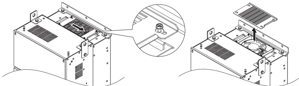
Abbildung 7.22 Entfernen des Lüfterschutzes
