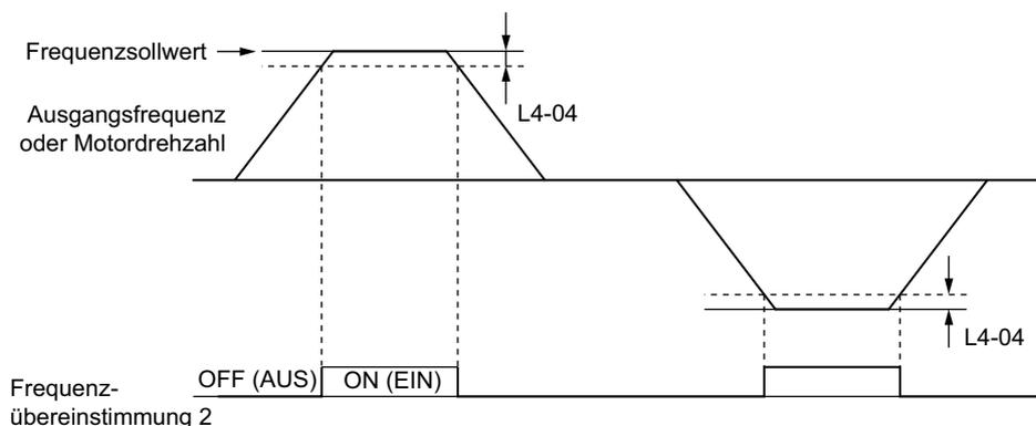
Abbildung 5.72 Ablaufdiagramm für Frequenzübereinstimmung 2
