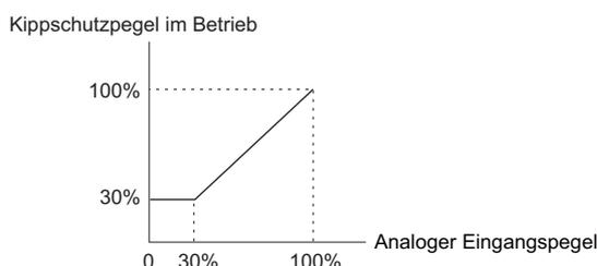
Abbildung 5.83 Kippschutz im Betrieb mit Analogeingangsklemme
