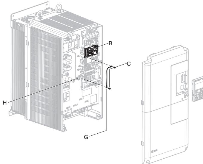
Abbildung 8.5 Anschließen des Erdungsleiters
