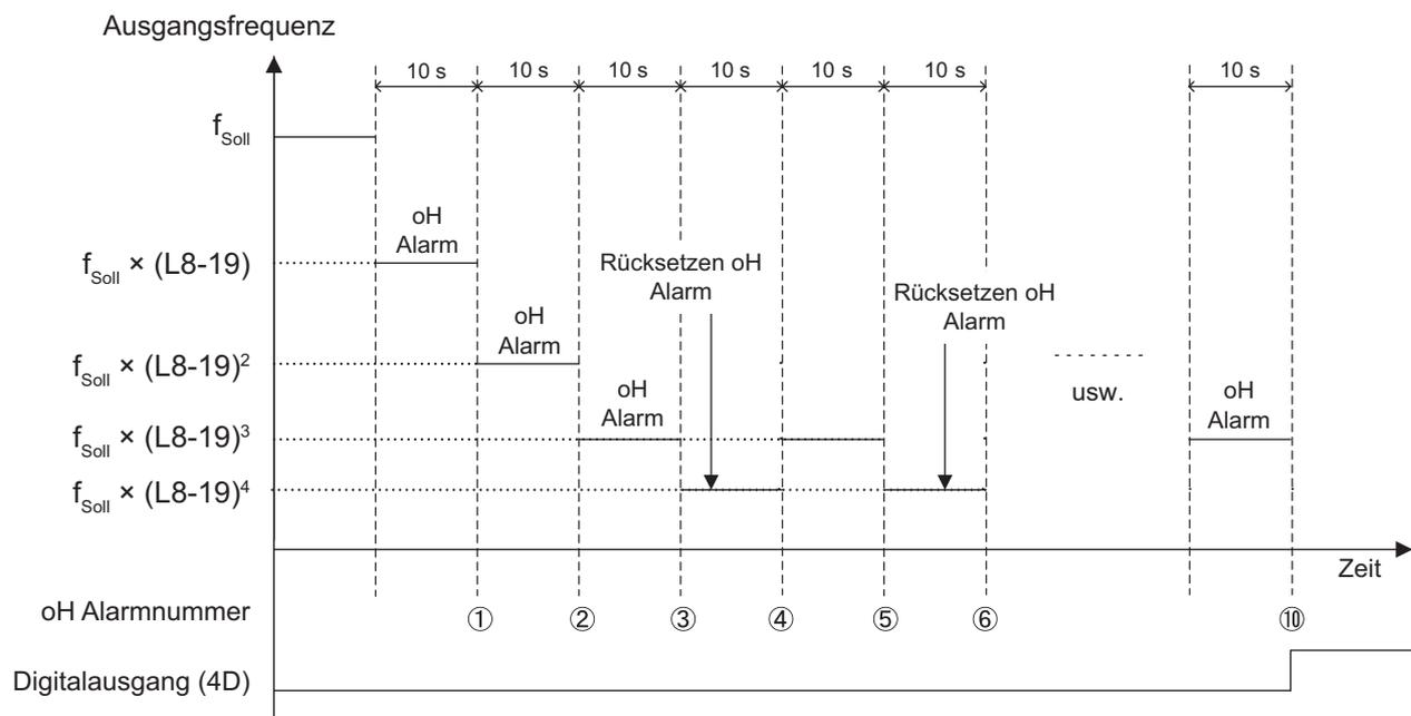
**Abbildung 5.101** Verringerung der Ausgangsfrequenz bei Temperaturalarm
