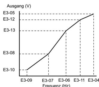
Abbildung 5.55 U/f-Kennlinie für Motor 2
