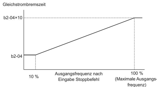
Abbildung 5.8 Gleichstrom-Bremsdauer in Abhängigkeit von der Ausgangsfrequenz
