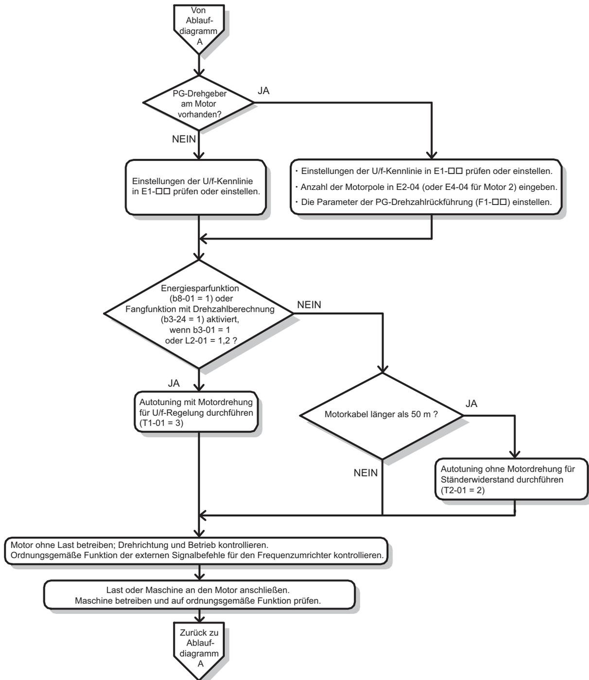
**Abbildung 4.9 Einfache Motoreinstellung mit Energiesparfunktion oder Fangfunktion**
