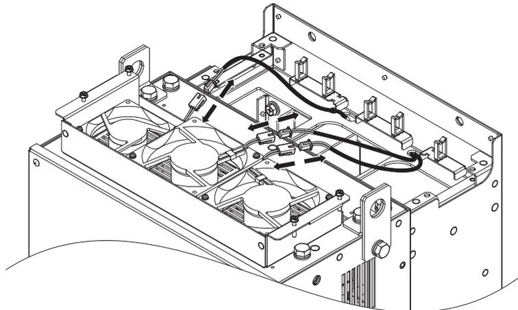
Abbildung 7.13 Steckverbindung der Lüftereinheit lösen
