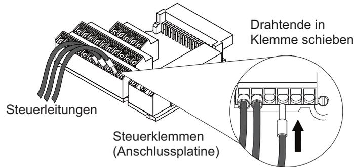
**Abbildung 3.28** Anleitung für die Verdrahtung der Steuerklemmen
