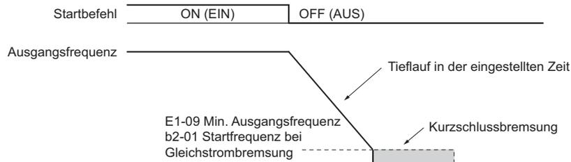
**Abbildung 5.4 Leerlauf bis zum Stillstand (OLV/PM, AOLV/PM)**
