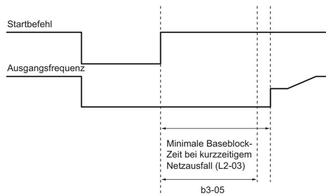
**Abbildung 5.19 Ablaufdiagramm für die Fangfunktion beim Anlauf**
