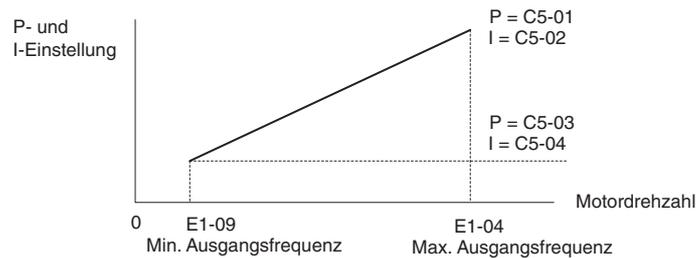
Abbildung 5.39 ASR-Verstärkung und Integrationszeit bei U/f-Regelung mit PG
