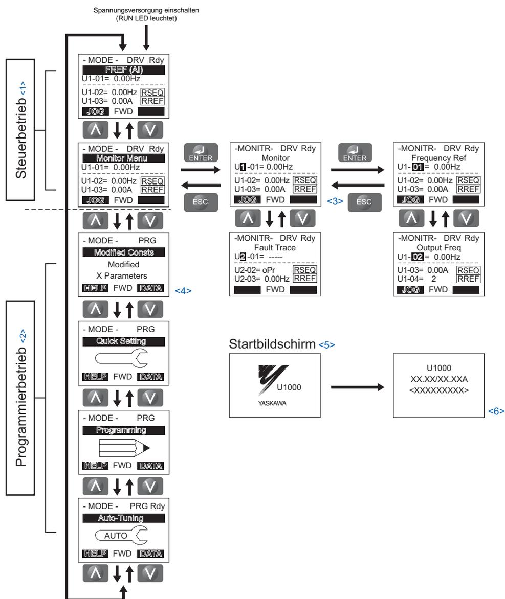
Abbildung 4.5 Menü für das digitale Bedienteil und Menüstruktur
