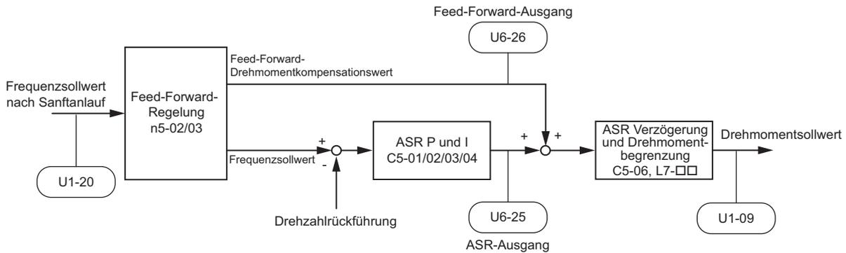
**Abbildung 5.103 Feed-Forward-Regelung**
