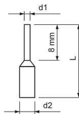
**Abbildung 3.27 Abmessungen der Aderendhülsen**
