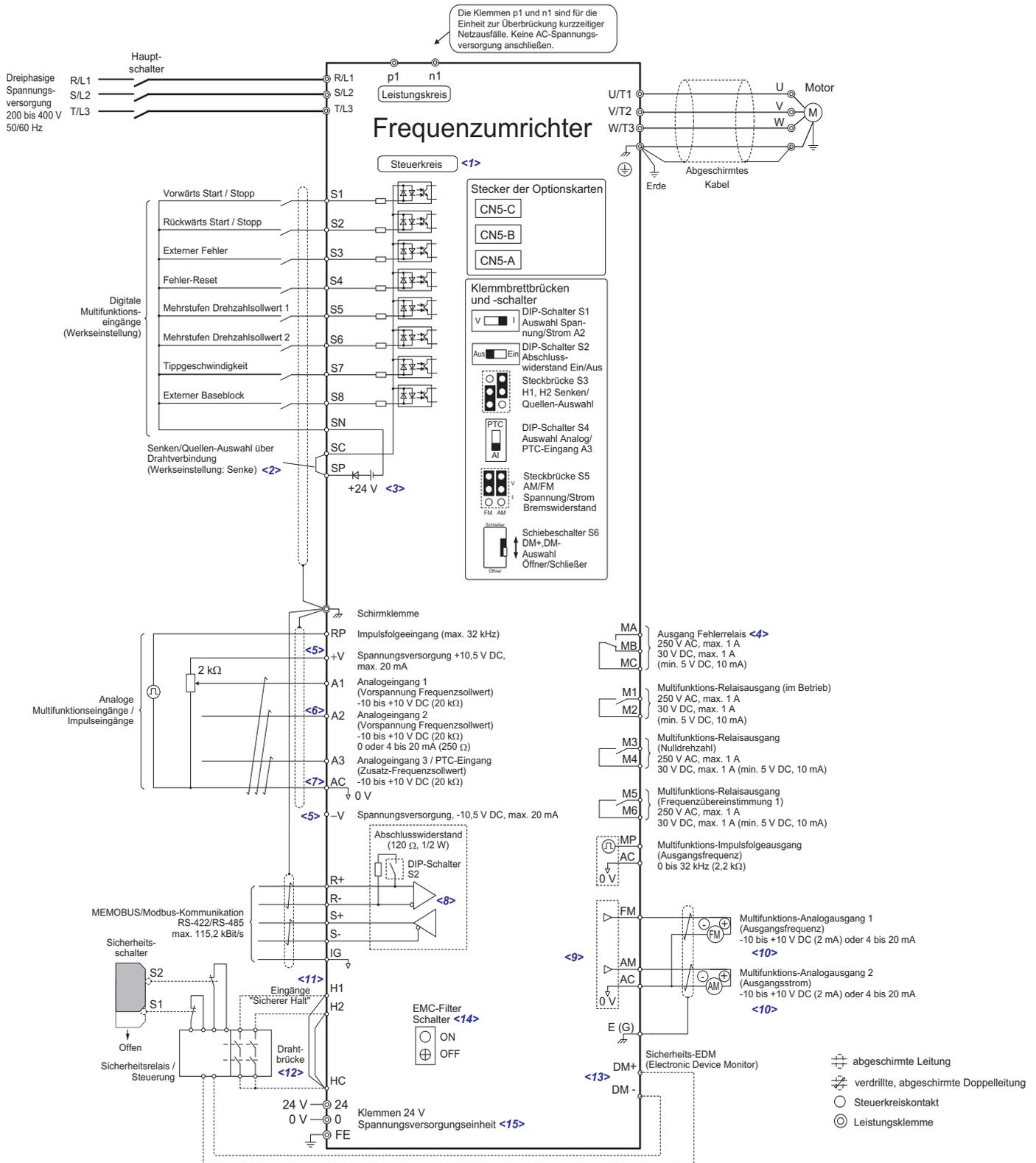
Abbildung 3.1 Standard-Anschlussdiagramm des Frequenzumrichters (Beispiel: CIMR-U□□0028)
