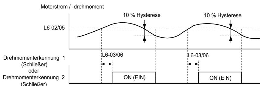
Abbildung 5.98 Funktionsweise bei Erkennung einer mechanischen Motorüberlast
