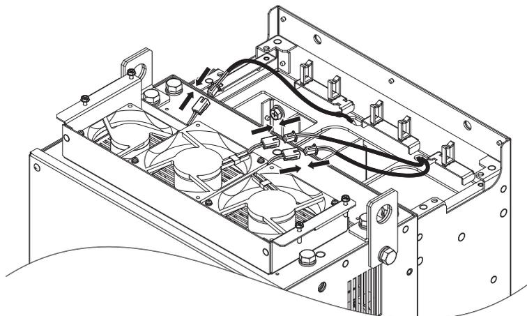
Abbildung 7.14 Steckverbindung der Lüftereinheit herstellen
