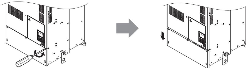
Abbildung 3.11 Entfernen der Klemmenabdeckung
