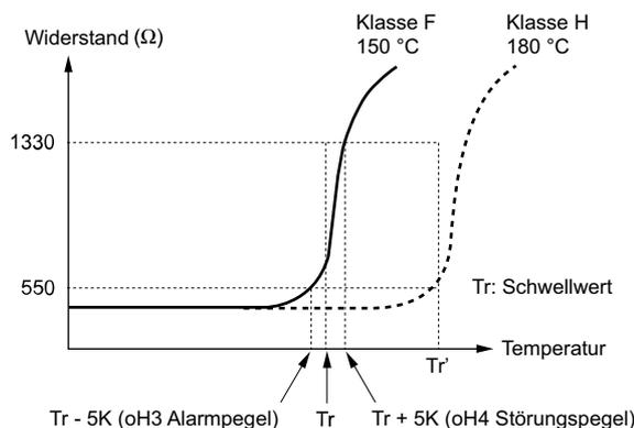
Abbildung 5.90 Motor-PTC-Kennwerte
