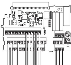
Abbildung 7.40 Gelöste und abnehmbare Steuerkreisklemmen-Baugruppe
