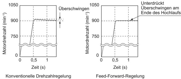
**Abbildung 5.102 Unterdrückung von Überschwingen durch Feed-Forward-Regelung**
