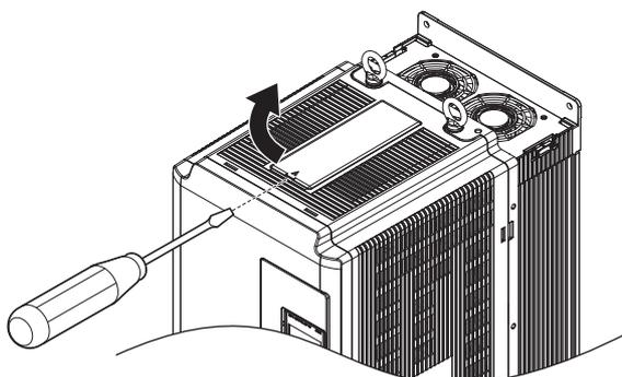
Abbildung 3.21 Abnehmen der oberen Schutzabdeckung
