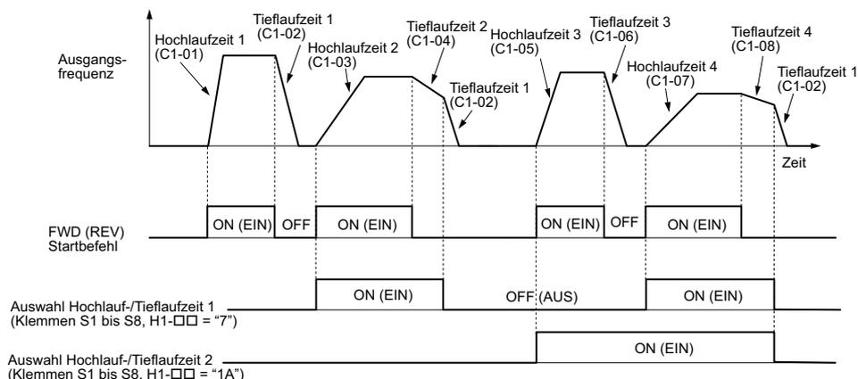
**Abbildung 5.32 Ablaufdiagramm für Änderungen der Hochlauf-/Tieflaufzeiten**
