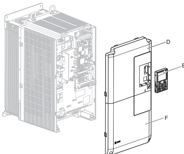
Abbildung 8.3 Abnehmen der Frontblenden und des Bedienteils
