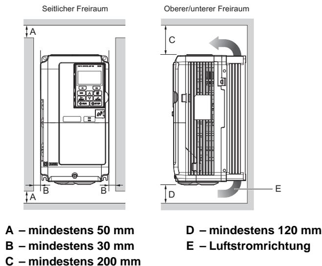
**Abbildung 2.2 Korrekte Einbauabstände**
