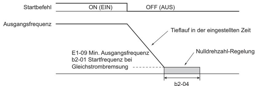
**Abbildung 5.5 Nulldrehzahl-Regelung beim Anhalten in CLV und CLV/PM**
