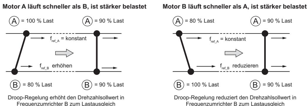
Abbildung 5.29 Droop-Regelung in einer Traversenkran-Anwendung
