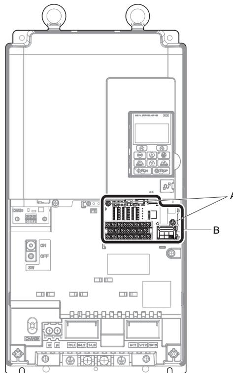
A – Befestigungsschrauben für die Anschlussplatine
