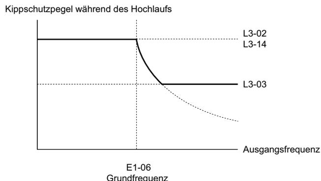
Abbildung 5.94 Kippschutzpegel und Grenzpegel beim Hochlauf
