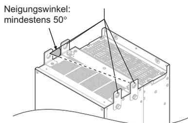
**Abbildung 2.7** Aufhängung des Frequenzumrichters mit Drahtseilen und Befestigungswinkeln (2□0154 bis 2□0248, 4□0156 bis 4□0414)
