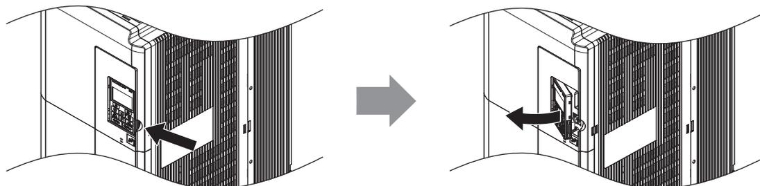
Abbildung 3.14 Abnehmen des digitalen Bedienteils
