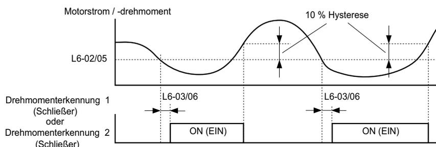
**Abbildung 5.99 Funktionsweise bei Erkennung einer mechanischen Motorunterlast**
