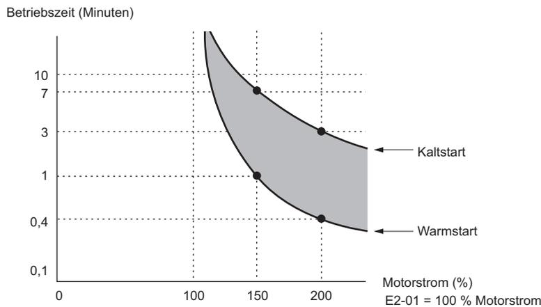
Abbildung D.6 Motor-Überlastschutzzeit
