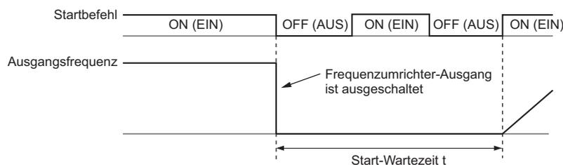
Abbildung 5.9 Leerlauf bis zum Stillstand über Timer
