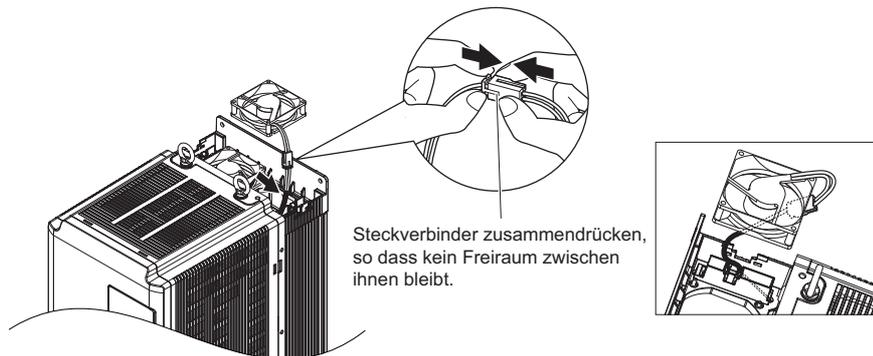
Abbildung 7.5 Steckverbindung des Lüfters herstellen
