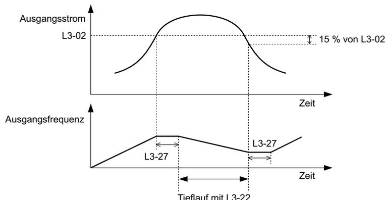
Abbildung 5.92 Kippschutz beim Hochlauf für Permanentmagnetmotoren
