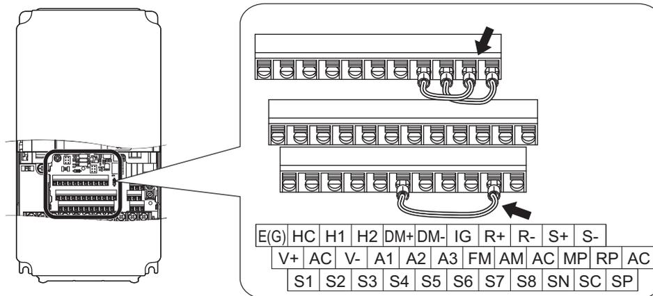
**Abbildung C.8 Klemmenanschlüsse für die Kommunikations-Selbstdiagnose**
