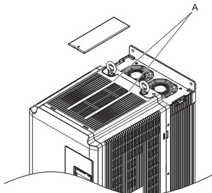
A – Montagebohrungen für die obere Schutzabdeckung
