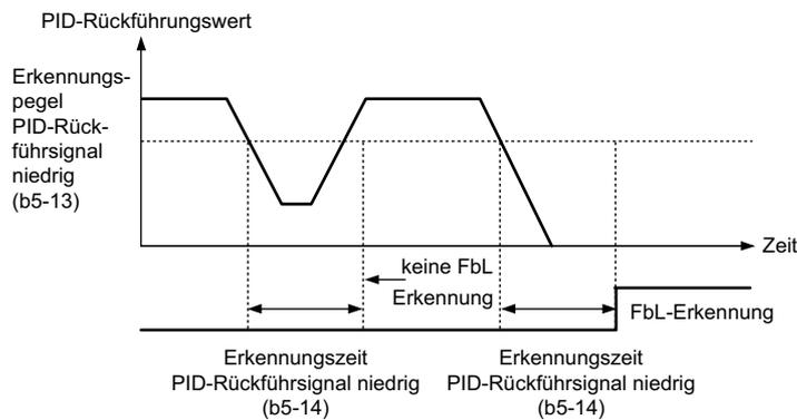
Abbildung 5.26 Erkennung des Ausfalls der PID-Rückführung
