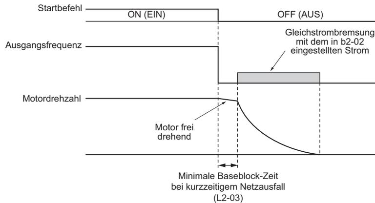
Abbildung 5.7 Gleichstrombremsung bis zum Stillstand
