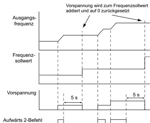
Abbildung 5.47 Beispiel für Aufwärts/Abwärts 2 mit Frequenzsollwert vom digitalen Bedienteil und d4-01 = 1
