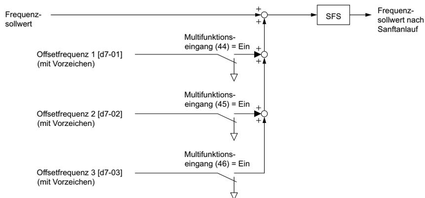
Abbildung 5.53 Funktionsweise der Offsetfrequenz-Funktion
