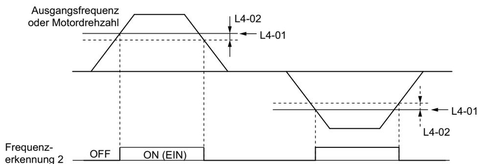
Abbildung 5.71 Ablaufdiagramm für Frequenzerkennung 2
