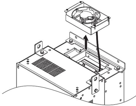
Abbildung 7.24 Ausbau der Lüftereinheit
