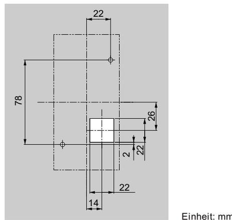
**Abbildung 2.11 Abmessungen des Schrank-Ausschnittes (Externe/Frontmontage)**
