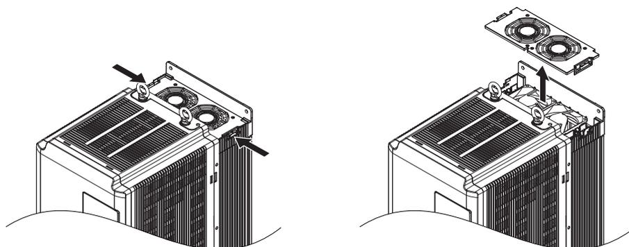
Abbildung 7.2 Entfernen des Lüfterschutzes
