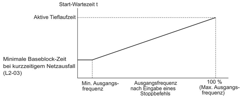
Abbildung 5.10 Run-Wartezeit in Abhängigkeit von der Ausgangsfrequenz
