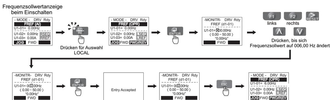
**Abbildung 4.6** Einstellung des Frequenzsollwertes im Steuerbetrieb
