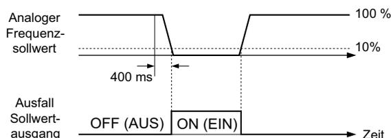
Abbildung 5.97 Funktionsweise der Sollwertausfallerkennung
