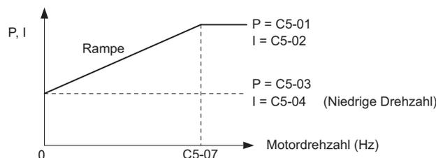
Abbildung 5.40 Verstärkungseinstellungen für niedrige und hohe Drehzahl
