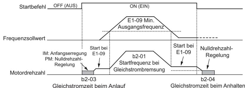
Abbildung 5.14 Betrieb bei der minimalen Frequenz
