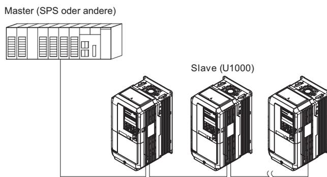
Abbildung C.1 Anschluss mehrerer Frequenzumrichter an eine SPS
