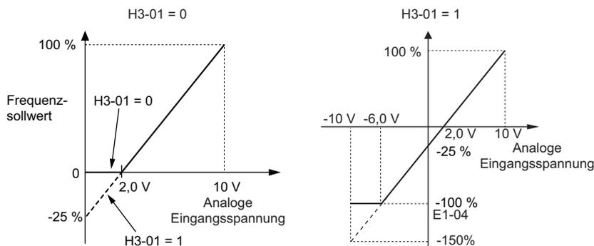
Abbildung 5.80 Frequenzsollwert-Einstellung durch Analogeingang mit negativer Vorspannung
