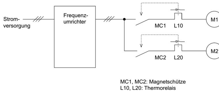
Abbildung 5.87 Beispiel für die Auslegung des Schutzkreises für mehrere Motoren
