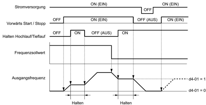
Abbildung 5.46 Halten des Frequenzsollwertes mit Hochlauf-/Tiefauflauf-Haltefunktion
