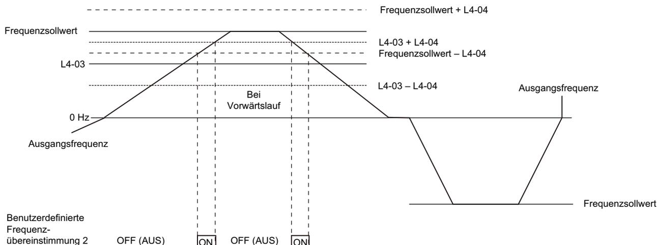
Abbildung 5.73 Beispiel mit positivem L3-04-Parameterwert für benutzerdefinierte Frequenzübereinstimmung 2
