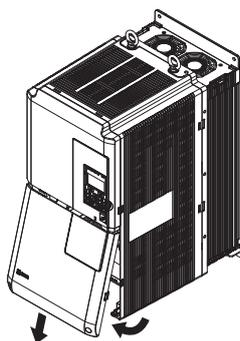
Abbildung 3.9 Entfernen der Klemmenabdeckung
