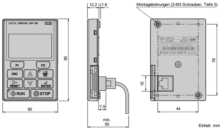
Abbildung 2.9 Abmessungen des digitalen Bedienteils
