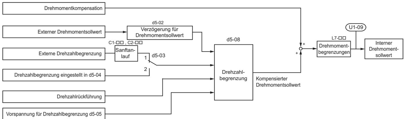
Abbildung 5.51 Blockschaltbild der Drehmomentregelung
