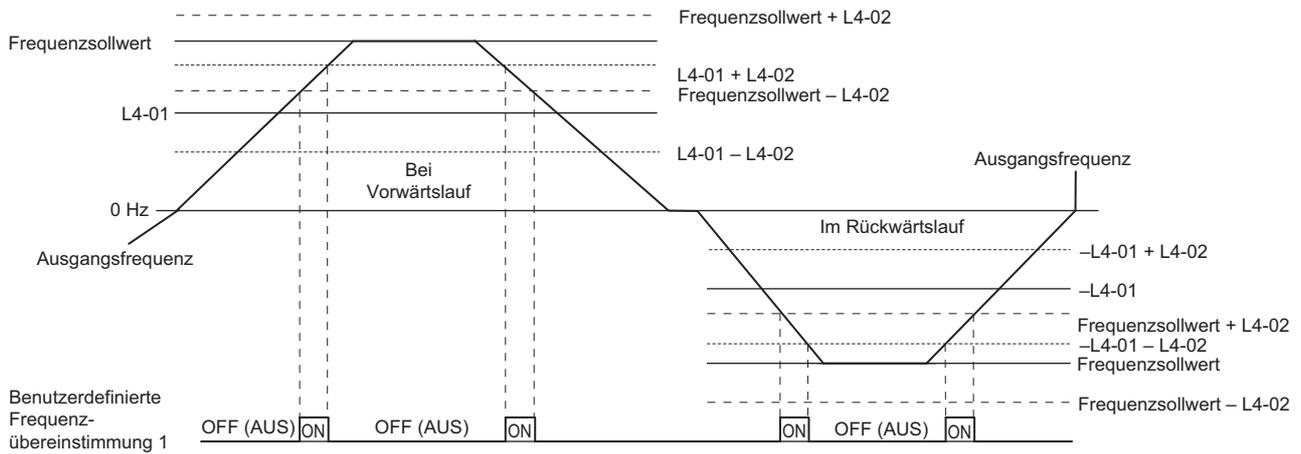
Abbildung 5.69 Ablaufdiagramm für benutzerdefinierte Frequenzübereinstimmung 1
