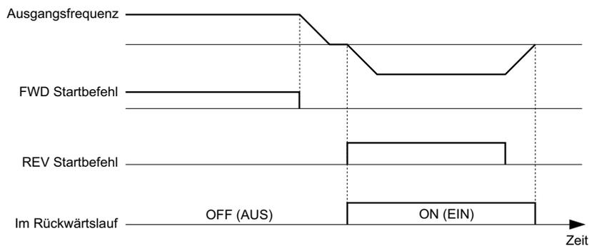
Abbildung 5.76 Beispiel für Ablaufdiagramm des Rückwärtslauf-Ausgangs
