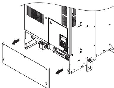
Abbildung 3.12 Entfernen der Klemmenabdeckung
