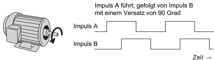
Abbildung 8.16 Versatz der Impulse A und B
