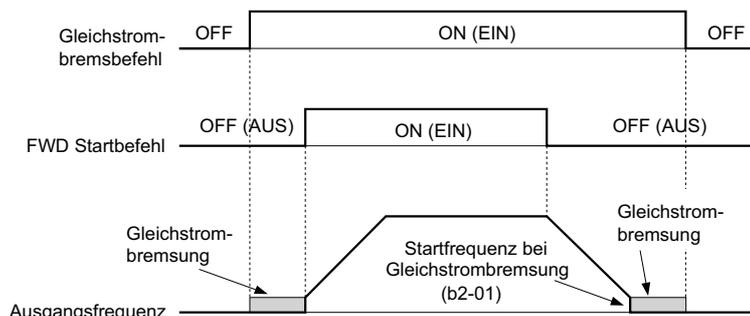
Abbildung 5.65 Ablaufdiagramm Gleichstrombremseingang
