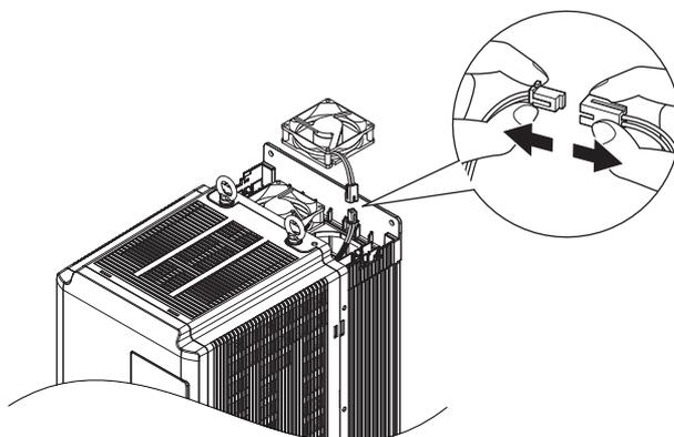
Abbildung 7.4 Trennen der Steckverbindung des Lüfters
