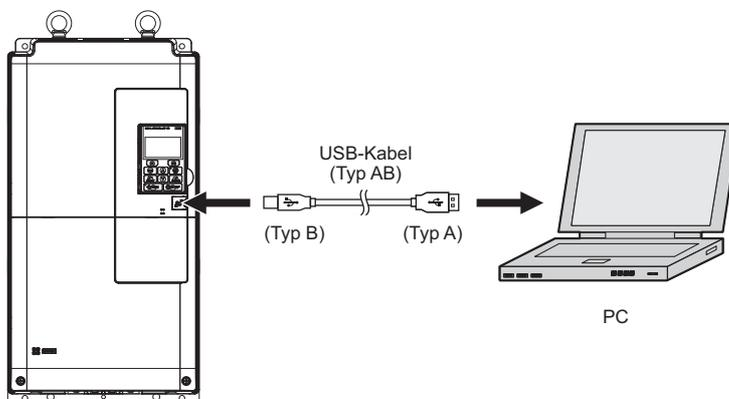
Abbildung 3.34 Anschluss an einen PC (USB)
