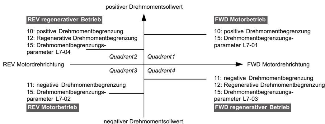
Abbildung 5.100 Einstellung der Drehmomentbegrenzungen durch Parameter und Analogeingänge
