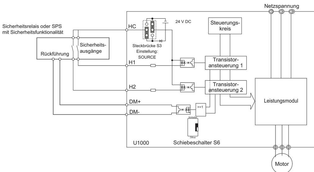
Abbildung D.8 Anschlussbeispiel Safe-Disable-Funktion (Quellen-Modus)
