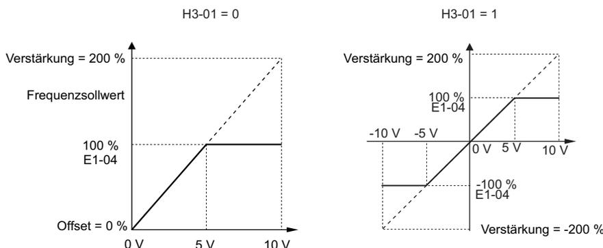
Abbildung 5.79 Frequenzsollwert-Einstellung durch Analogeingang mit erhöhter Verstärkung
