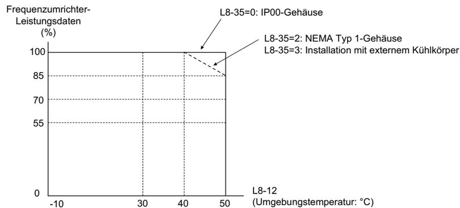
Abbildung A.2 Derating für Umgebungstemperatur und Installationsmethode
