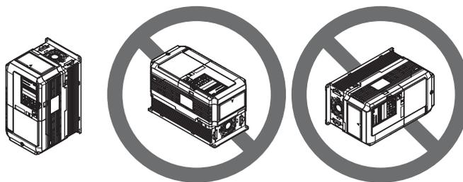
**Abbildung 2.1 Richtige Ausrichtung bei der Installation**
