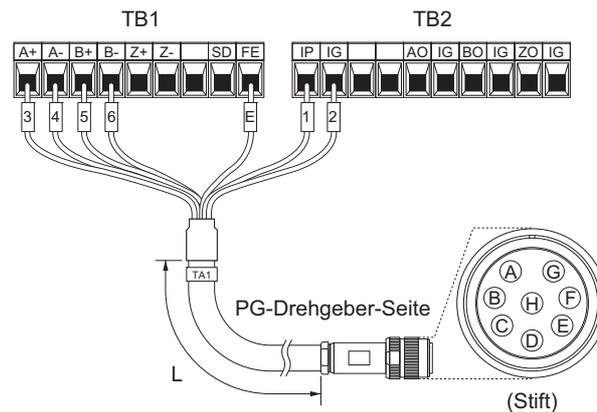
Abbildung 8.11 Verdrahtung der Drehgeberleitung
