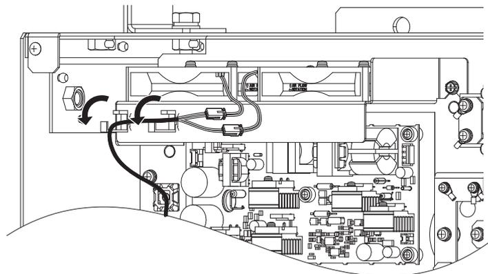
Abbildung 7.32 Entriegeln der Kabelhaken
