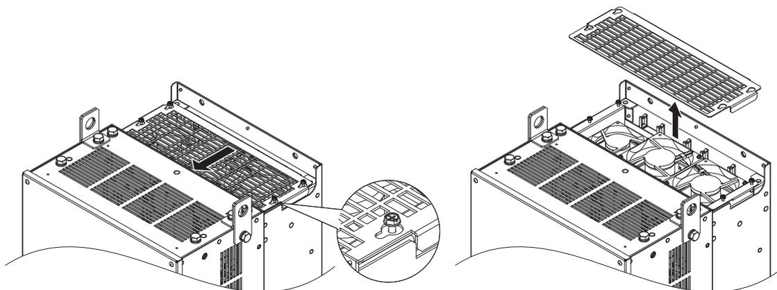
Abbildung 7.10 Entfernen des Lüfterschutzes
