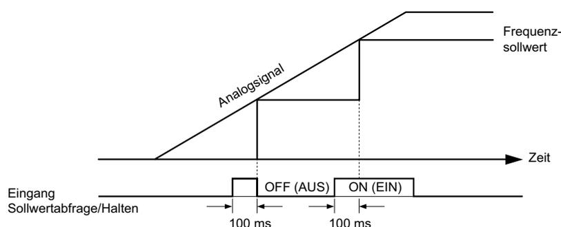
**Abbildung 5.63 Abfrage/Halten Analoges Frequenzsollwert**
