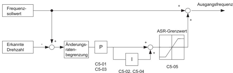
Abbildung 5.37 Blockschaltbild der Drehzahlregelung für U/f-Regelung mit PG
