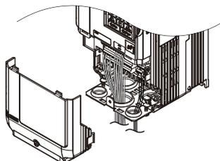
Abbildung 7.37 Entfernen der Klemmenabdeckung
