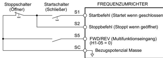
Abbildung 5.56 Stromlaufplan für 3-Draht-Ansteuerung
