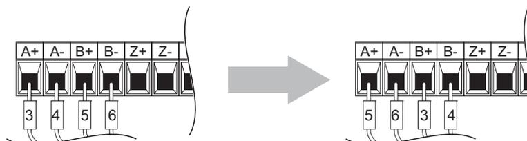
Abbildung 8.17 Tauschen der Drähte von Kanal A und Kanal B
