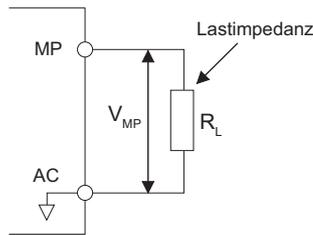
Abbildung 3.32 Impulsausgangsanschluss unter Verwendung der internen Versorgungsspannung
