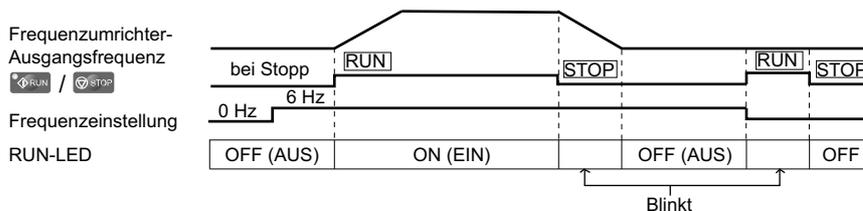
Abbildung 4.4 RUN-LED und Steuerbetrieb
