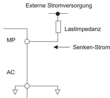
Abbildung 3.33 Impulsausgangsanschluss unter Verwendung der externen Versorgungsspannung
