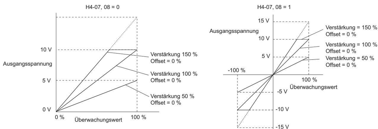
Abbildung 5.84 Beispiele 1 und 2 für Verstärkungs- und Vorspannungseinstellung für Analogausgang
