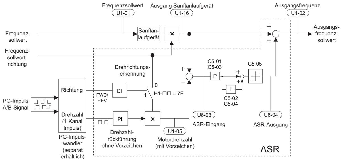
Abbildung 5.86 Drehzahlregelung mit ASR in U/f mit einfacher Drehzahlrückführung
