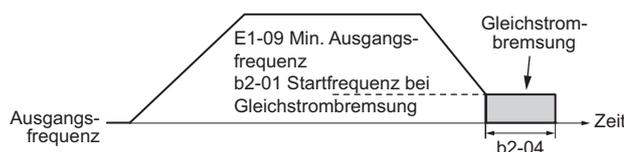
Abbildung 5.16 Gleichstrombremsung bei Anhalten für U/f, U/f mit PG und OLV
